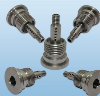
品名: 内六角、小孔加工 六角穴加工、Φ0.3穴加工 材料: SUS303/SUM24L 表面处理: 镀锌、电解抛光 クロメート、電解研磨
