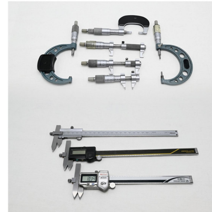
内外径千分尺/数显中心距卡尺 内外径マイクロメータ/中心ピッチノギス (Mitutoyo) Inside and outside micrometer / Digital display center distance caliper
