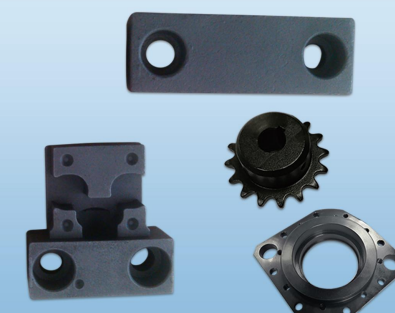
品名: 齿轮、垫块 ギヤー、ブロック 材料: S45C/SUS440C 表面处理: 发黑、热处理、氮化 黒染め、熱処理、タフトライド
