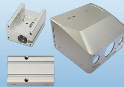
品 名: 箱体精密加工 ケース精密加工 材 料: A6061/A6063 表面处理: 喷砂、银色亮光阳极 プラスト、銀アルマイト
